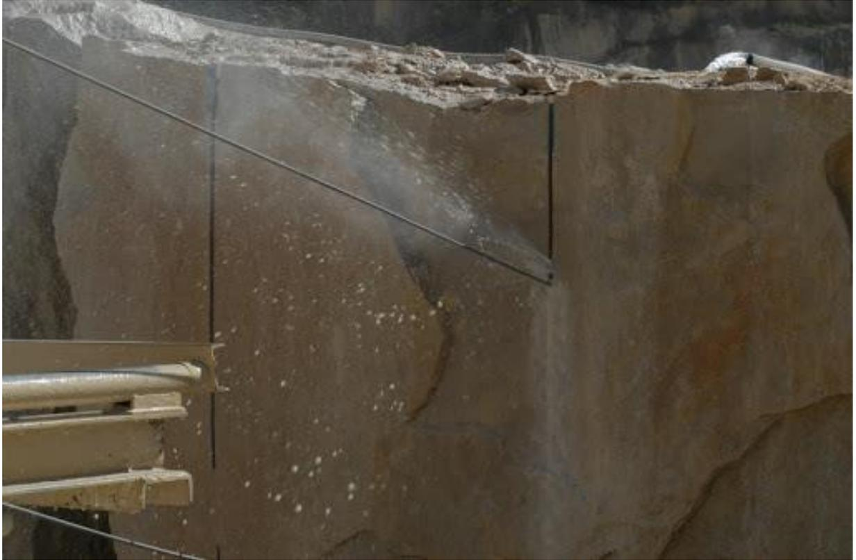
**Figure 2.9** : exemple de sciage par le câble diamanté (snroc.fr).
