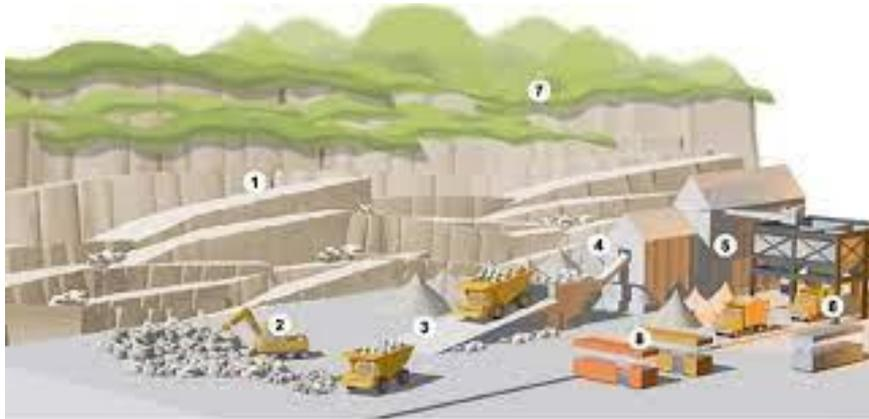
**Figure 2.11** : Schéma représentatif sur les étapes d'extraction de  $\text{CaCO}_3$  (drill-i.com)
